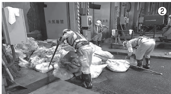
鳶口（とびぐち）を使用し、不適物が混入していないかを確認します。
