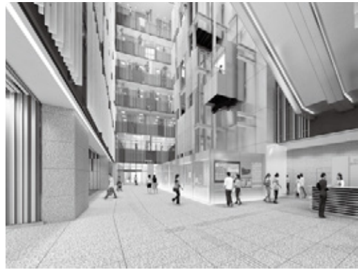
1階のアトリウムから9階までエコヴォイド (自然換気、自然採光)を採用
