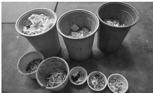
④分類したごみを計量し、一部を持ち帰ります。持ち帰った試料は、機器を用いて詳細に分析します。
