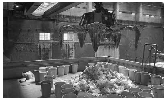
①はじめに、ごみを貯めておくごみバンクからごみクレーンで試料を500kg程度採取します。
