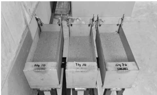
(写真6)小型コンテナを用いた灰の固着を再現した実験
