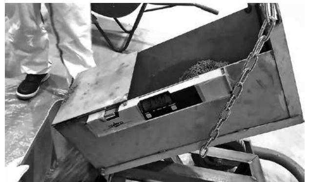
(写真7)小型コンテナを用いた灰の荷下ろし実験
