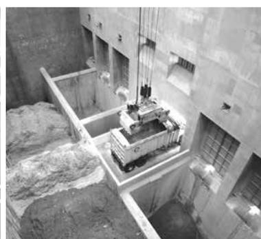
船舶輸送用コンテナへの灰の積込み
