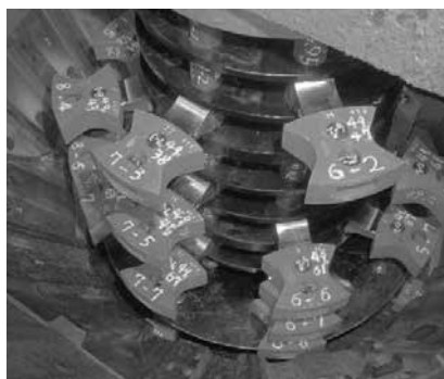
破砕機内部のハンマー
