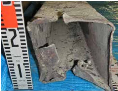
▲江戸川清掃工場に搬入された軽量鉄骨（180cm × 20cm × 20cm）（令和2年7月故障発生）
