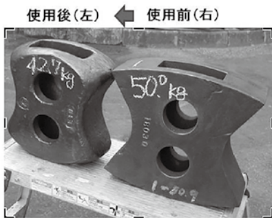
約2か月の破砕量は約9,000トンで、鑄鉄製のハンマーがこんなに擦り減ります。
