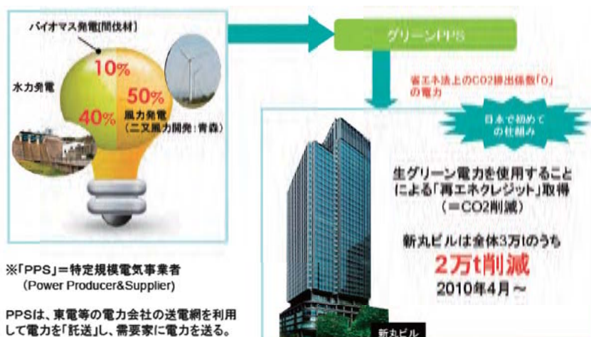
図: 生グリーン電力供給の事例(三菱地所(株)資料より)
